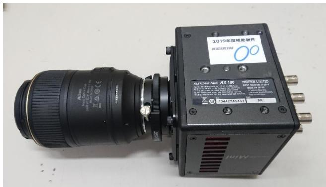
測定に使用したハイスピードカメラ（補助物件）
